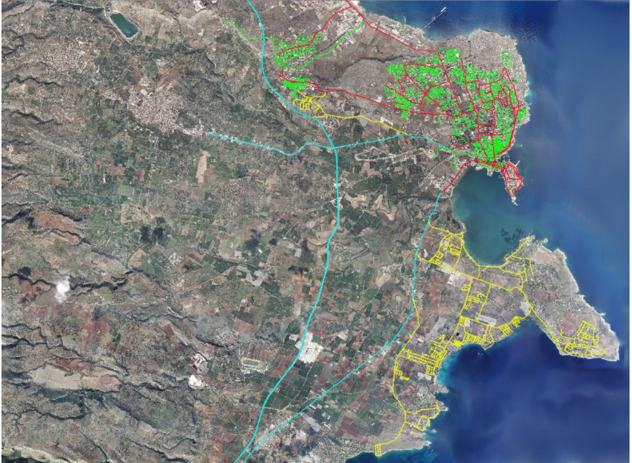
Fig. 2.2 – Assi viari principali urbani (rosso), Assi viari secondari urbani (verde), Assi viari principali extraurbani (ciano), Assi viari secondari extraurbani (giallo).
